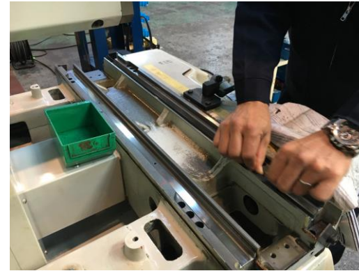
【ローラーベアリング取付部の調査】
