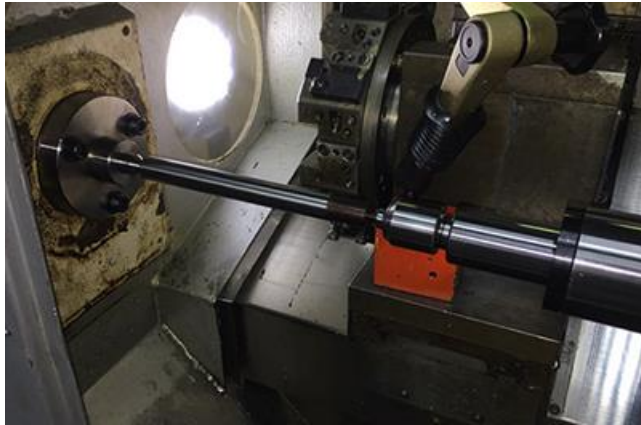
【芯押し台追加後の点検の様子】
