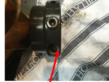
【取付部品のボルトの欠損による振動】
