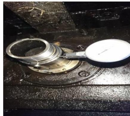
【シリンダーの取付フランジの端面振れ、外径の振れを修正】
